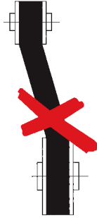
Axialer Versatz der Scheiben Axial misalignment of pulleys
