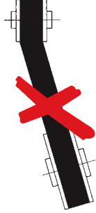
Horizontale Winkelabweichung der Achsen Horizontal angle deviation of the shafts
